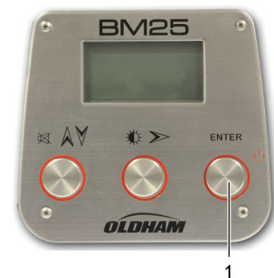
Figure 13 : mise en marche standard par appui sur la touche Enter
