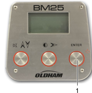
Figure 19 : mise à l'arrêt par appui sur la touche Enter
