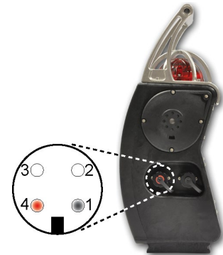
Figure 4 : le connecteur du chargeur local
